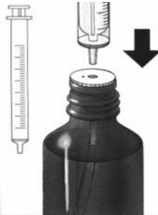
6. Die verordnete Lösungsmenge aufziehen (den unteren Rand des Messkolbens entsprechend dem verordneten Volumen an der Graduierung einstellen).
