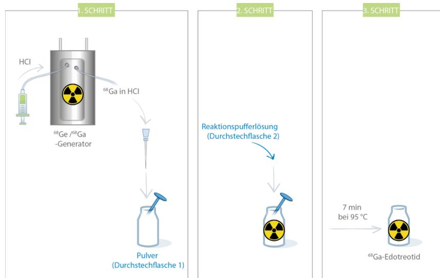
**Abbildung 2: Verfahren zur radioaktiven Markierung mit dem Galli Ad-Generator**
